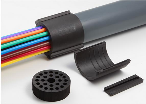
Die teilbare Rohrabdichtung eignet sich für die gas- und wasserdichte Abdichtung von 63 mm HDPE-Schutzrohren, die mehrere Subducts und/oder (Glasfaser-)Kabel enthalten.
