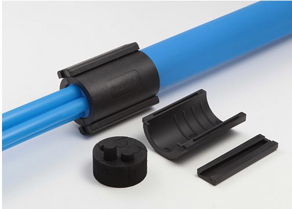
Die teilbare Rohrabdichtung eignet sich für die gas- und wasserdichte Abdichtung von 40 mm HDPE-Schutzrohren, die mehrere Subducts und/oder (Glasfaser-)Kabel enthalten.
