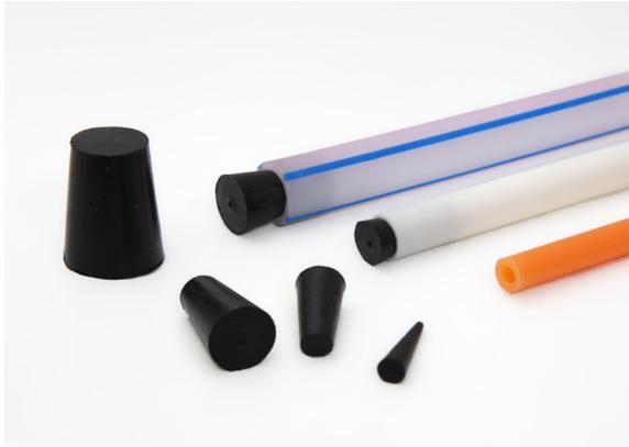
Die EPDM Gummi-Endstopfen sind für eine vorübergehende Abdichtung von Mikrorohren geeignet. Durch die Keilform der Endstopfen passen diese für verschiedenste Rohrdurchmesser. Sie sind geeignet von 4 mm bis 20 mm.
