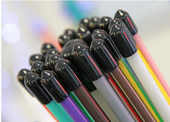
Die Endkappen dienen der Abdichtung und dem Schutz von Leerrohren und Rohrverbänden gegen das Eindringen von Wasser und Schmutz. Sie bestehen aus flexiblem Vinyl und sind verfügbar für Rohre von 4 mm bis 50 mm. Die Endkappen bieten hervorragenden mechanischen Schutz und sind resistent gegen Wasser, Öle, Fette und Säuren.
